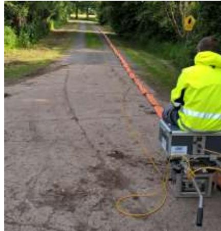
*Seismische Quelle (LIAG-Eigenentwicklung „ELVIS“) zur hochmobilen und schadensfreien mechanischen Wellenerzeugung im Untergrund und Geophon-Kette (Landstreamer) zur Signalaufzeichnung.*
